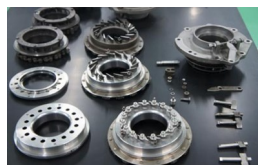
分解した可変ノズル。構成部品一つひとつを確認
