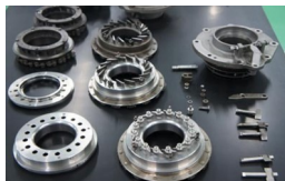
拆卸后的可变喷嘴。逐一确认构成零部件
