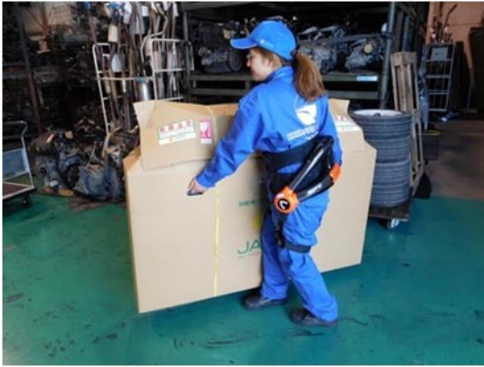
HAL을 장착한 상태에서 포장 작업을 하는 나카니시(中西) 씨. 여성도 무거운 것도 간단히 운반 가능하다
