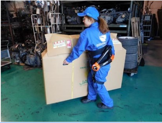
穿戴HAL进行捆包作业的中西，女性员工也可以很容易的搬运重物
