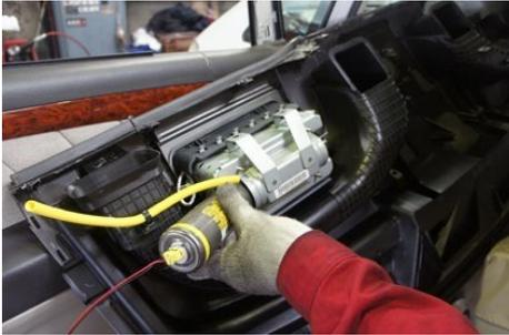
根据进口车车型的不同，从仪表板中拆卸气囊所需时间不一样
