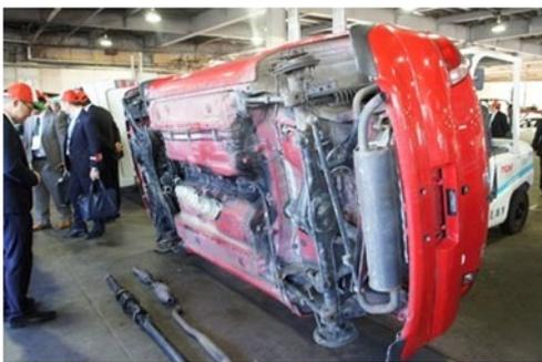
使用済み車の適正な解体処理の工程を見学
