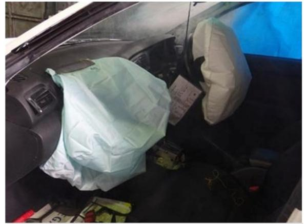
使用済み車のエアバッグは適正処理が義務付けられている。
